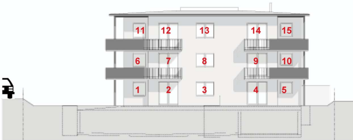
Bild A.3: Westansicht (inkl. Nummerierung der Öffnungen)
